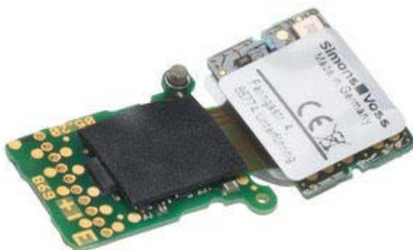
Der Digital Cylinder AX versorgt mit seinen Batterien anschließend auch den LockNode mit Energie. Ein federgelagerter Pin kontaktiert nach dem Zusammenbau die Kappe des Leseknaufs, um ähnlich wie eine Antenne drahtlos zu kommunizieren.
