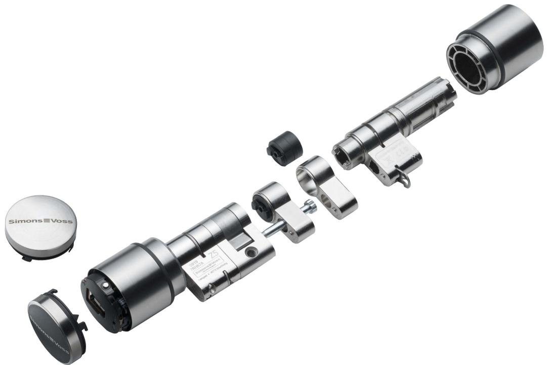
Der Digital Cylinder AX ist modular aufgebaut. Er besteht immer sowohl aus einem Zylinderprofil mit Bohrschutz und im Kern integriertem Aktor als auch einem Außen- und optional einem Innenknauf.
