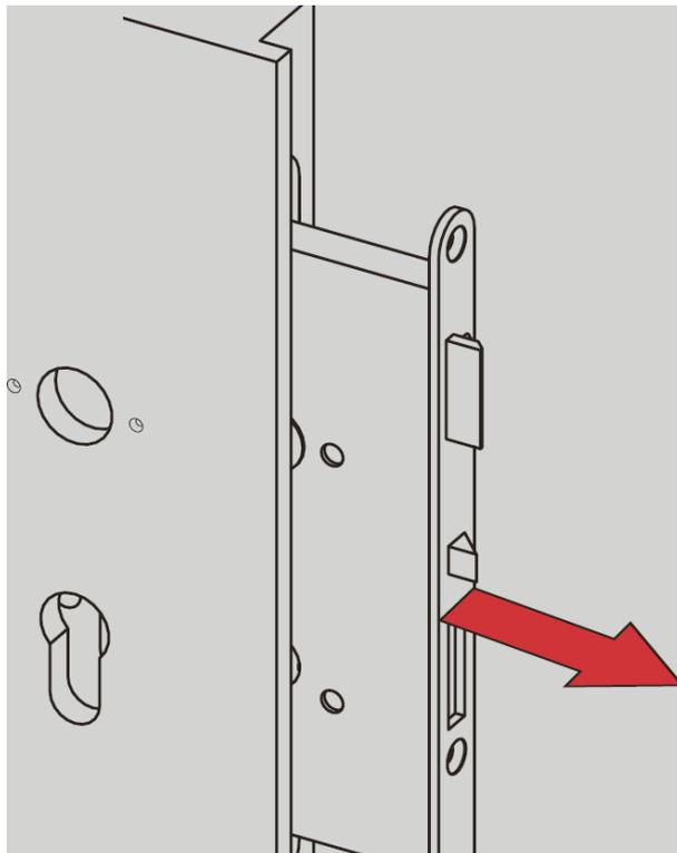
10. Wählen Sie - abhängig vom Durchmesser der Befestigungslöcher Ihres Einsteckschlusses (siehe Tabelle) - einen geeigneten Bohrer aus.
