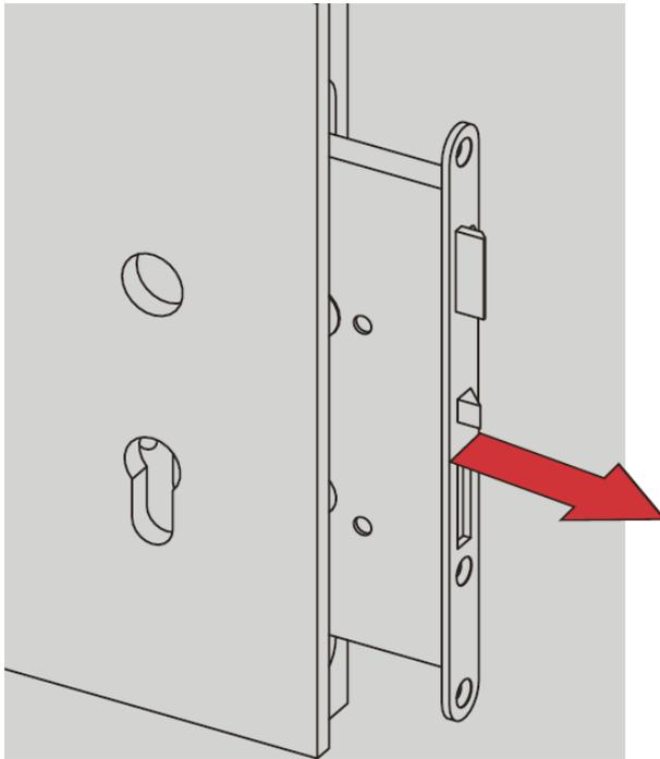
2. Messen Sie den Durchmesser der Befestigungslöcher am Einsteckschloss.
